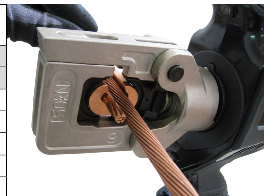
Kuvassa 50/25 mm 2 liitos C50-C25 liittimellä.
