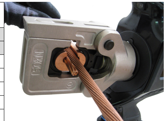
Kuvassa 50/25 mm 2 liitos C50-C25 liittimellä.
